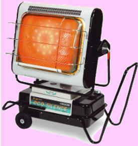
オリオンのエコサイレンスジェットヒーターブライトは、今までのブライトヒーターと比べて圧倒的な省エネと静音で環境に配慮した商品です。サーモ運転機能が追加されており設定温度に近づくにつれ 5段階の燃焼切替を自動で行います。又、設定温度より2℃上昇すると自動消火をする機能もついています。
